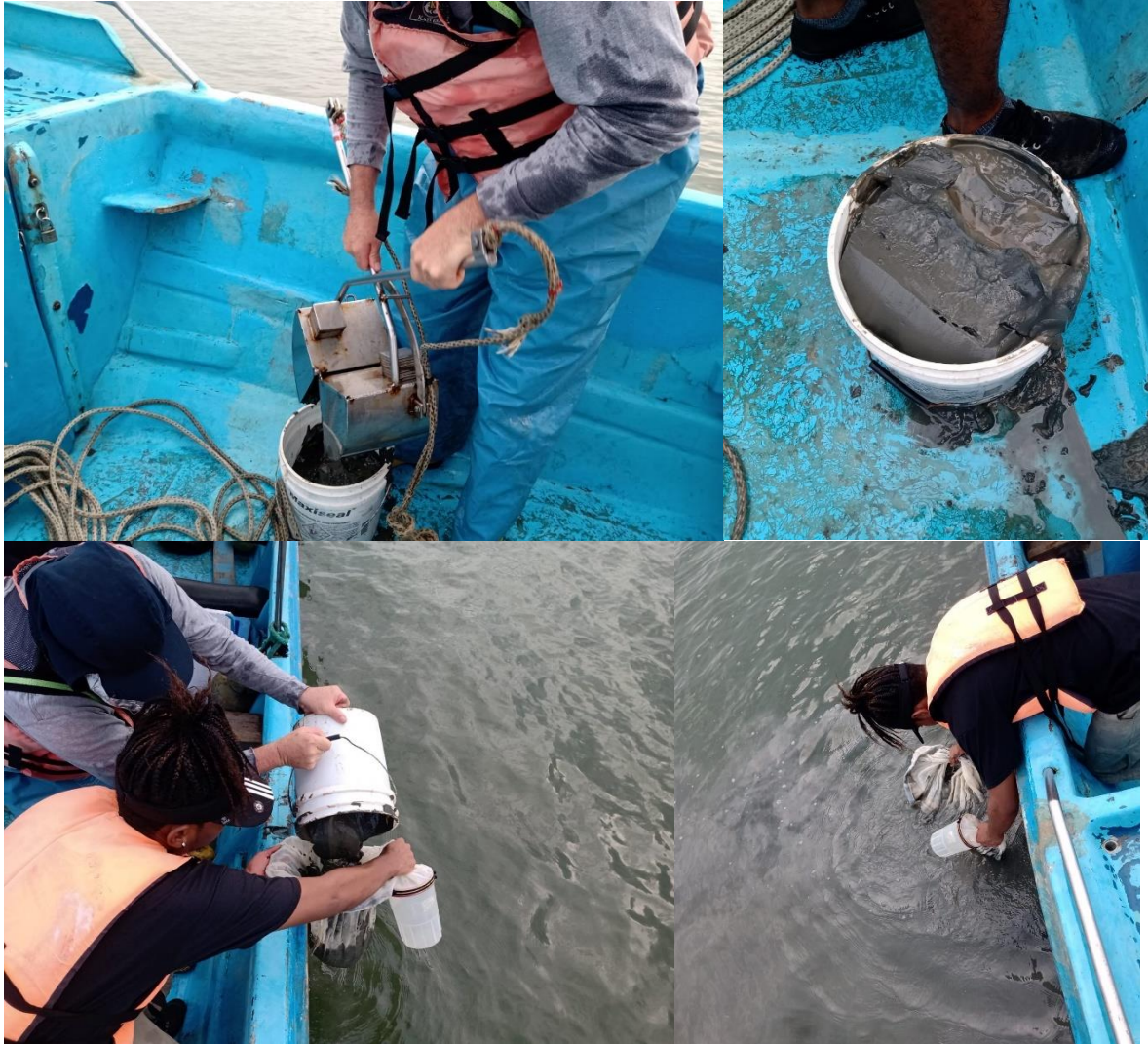
Fotografías 8 a 11: Muestra adquirida con draga tipo Van Been, reducida en tamiz de 300 micras para posterior fijación con alcohol al 70%.
