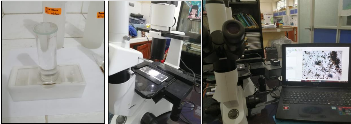
Fotografías 12 a 14: Análisis Fito planctónico en cámaras de Utermohl
