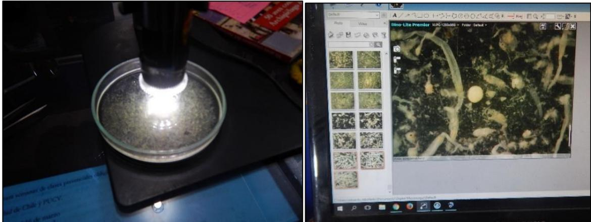
Fotografías 17 y 18: Análisis zoo planctónico, examinación en lupa de una fracción de masa conocida, imágenes proporcionadas por microscopio DINOLITE que facilitan identificación y conteos.
