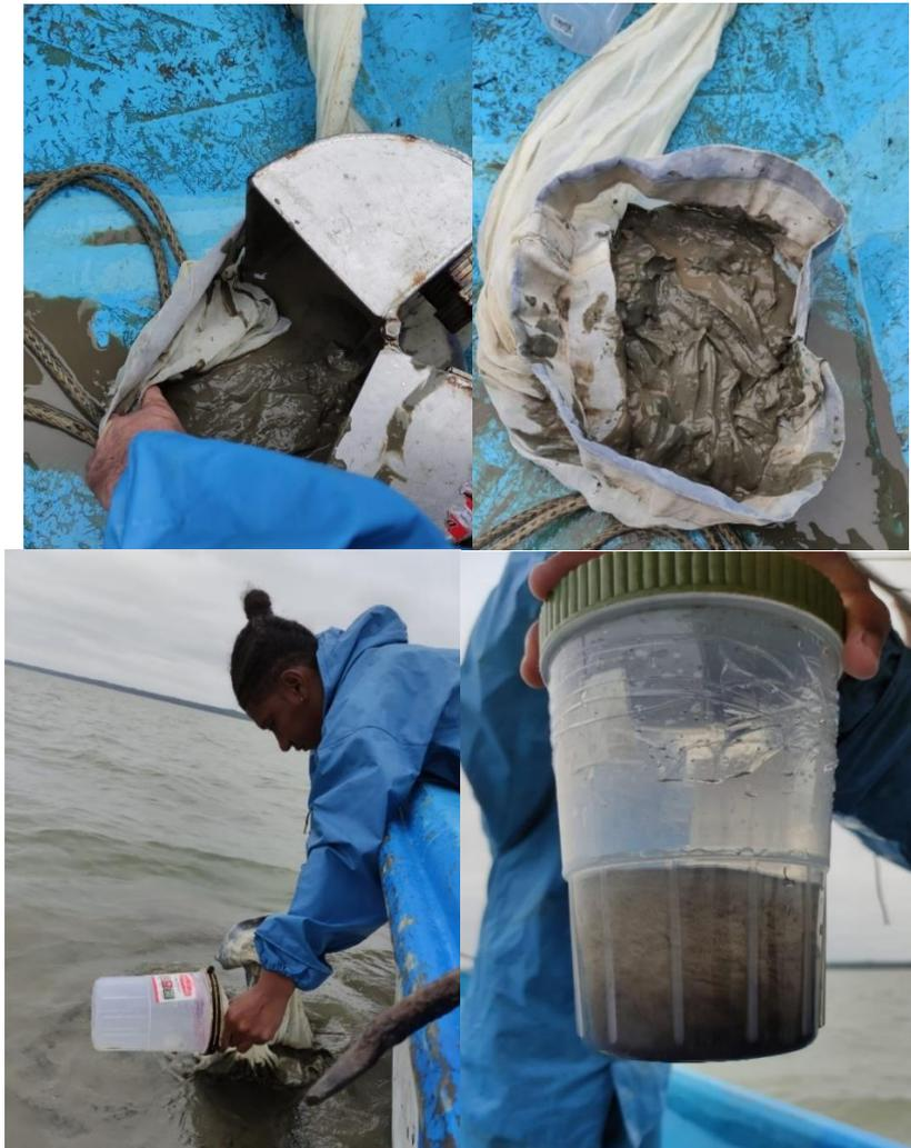
Fotografías 6 a 9: Muestra adquirida con draga tipo Van Been, reducida en tamiz de 500 micras para posterior fijación con alcohol al 96%.
