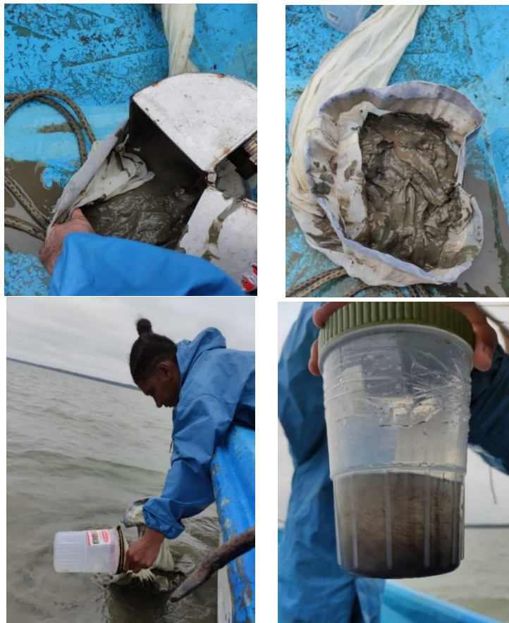
Fotografías 8 a 11: Muestra adquirida con draga tipo Van Been, reducida en tamiz de 500 micras para posterior fijación con alcohol al 96%.
