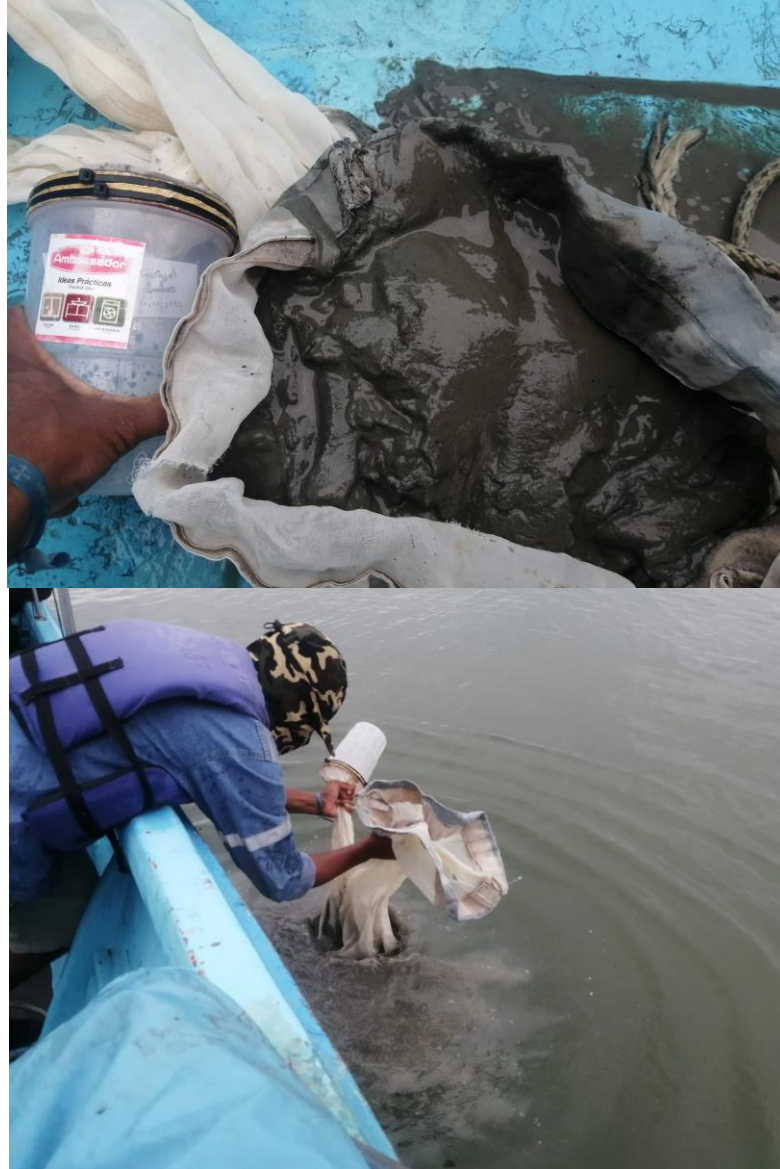
Fotografías 9 y 10: Muestra adquirida con draga tipo Van Been, reducida en tamiz de 500 micras para posterior fijación con alcohol al 96%.
