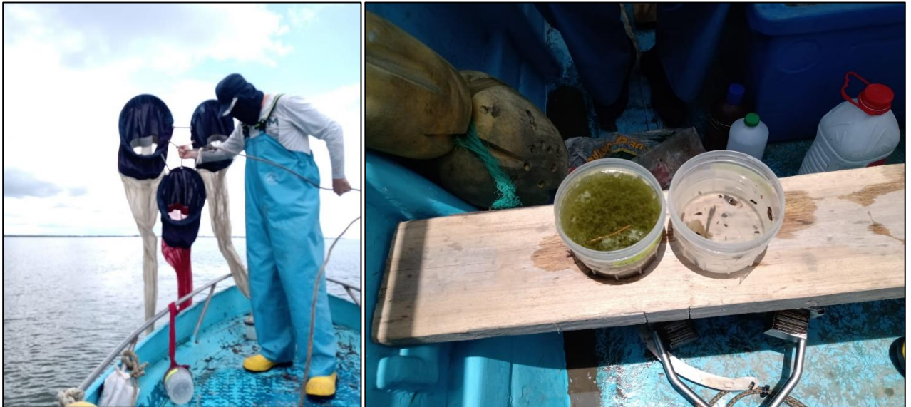
Fotografías 7 y 8 : Red tribongo empleada en arrastres horizontales y copos retirados con muestras concentradas de 300 y 500 micras
