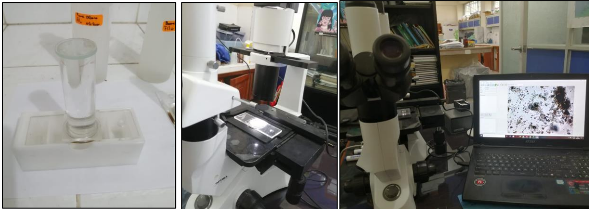
Fotografías 14 a 16: Análisis Fito planctónico en cámaras de Utermohl
