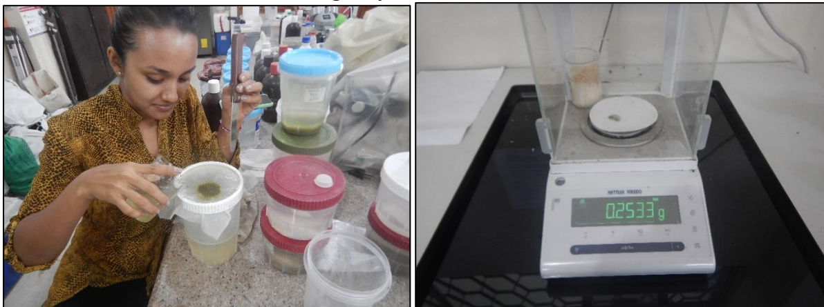
Fotografías 17-18: Estimación de biomasa plantónica, concentración de fracción menor a 60 micras.
