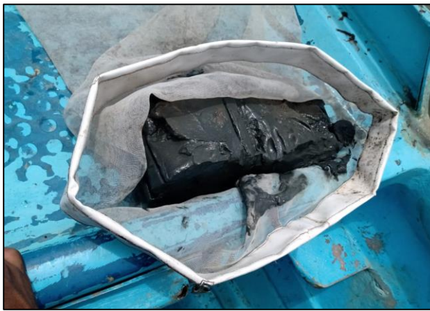
Fotografías 9 a 12: Muestra adquirida con draga tipo Van Been, reducida en tamiz de 300 micras para posterior fijación con alcohol al 70%.
