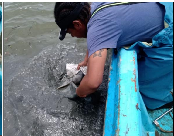
Fotografías 9 a 12: Muestra adquirida con draga tipo Van Been, reducida en tamiz de 300 micras para posterior fijación con alcohol al 70%.
