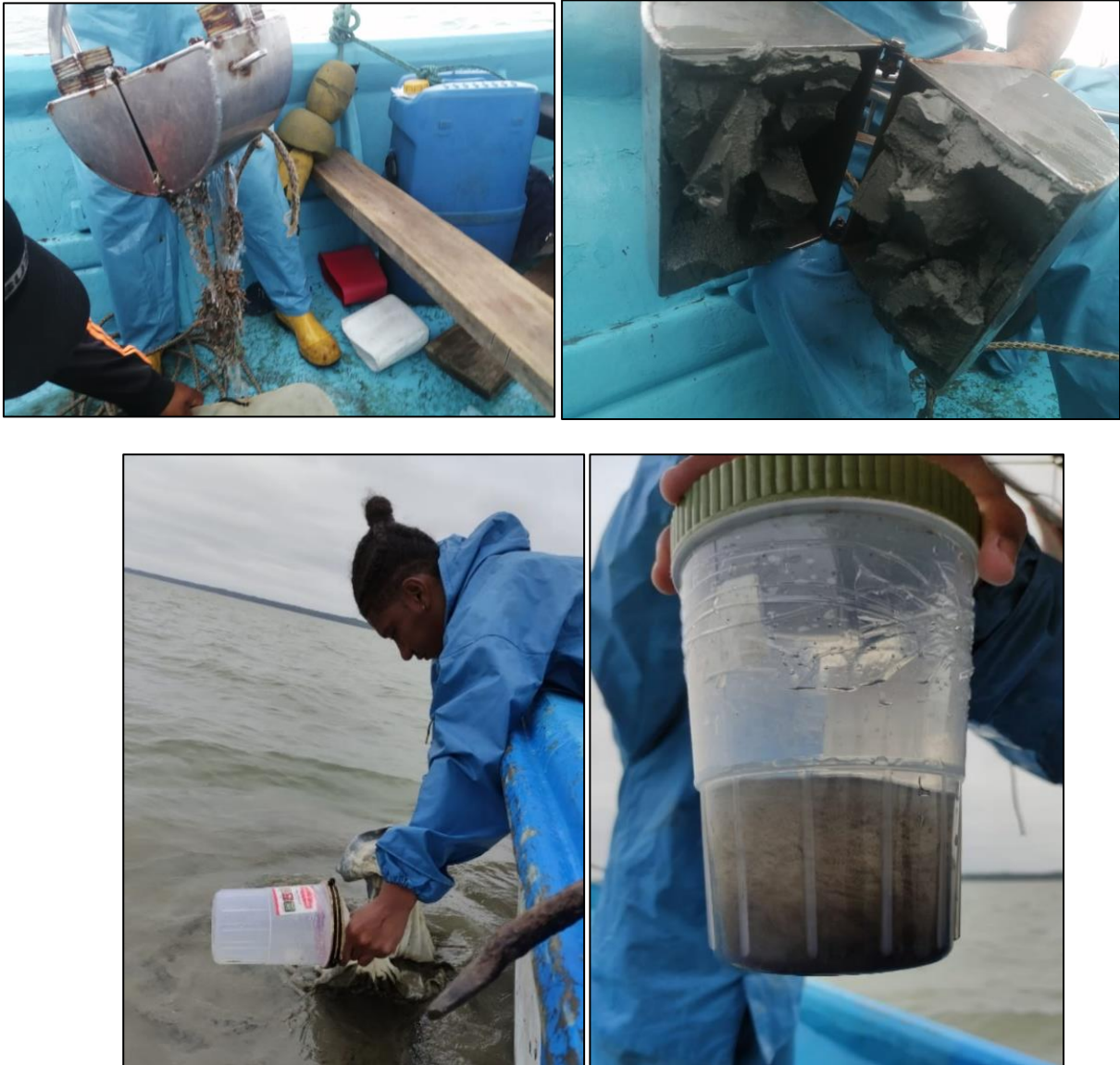
Fotografías 10 a 13: Muestra adquirida con draga tipo Van Been, arriba izquierda colecta de redes en desuso en Barra externa, arriba derecha sedimentos compactos en barra interna 1, abajo derecha reducción de muestra en tamiz y muestra concentrada fijada con alcohol al 70%.
