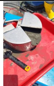
Fotografía 2. Uso de draga tipo Van Veen y apariencia de la muestra
