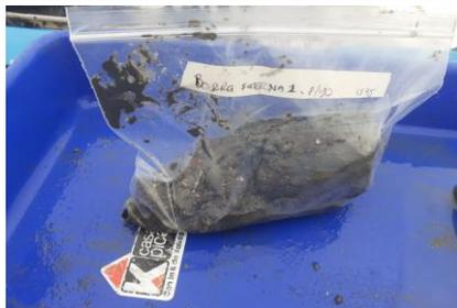
Fotografía 3. Homogenización de la muestra
