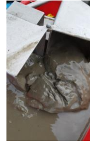
Fotografía 2. Uso de draga tipo Van Veen
