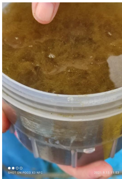
Fotografía 7: Exceso de algas fibrilares en copo de 60 micras
