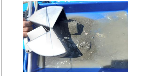
Fotografía 2. Uso de draga tipo Van Veen
