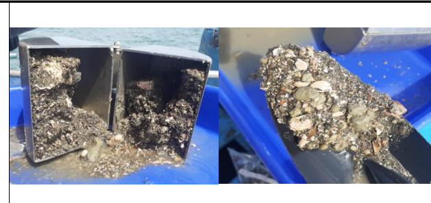
Fotografía 2. Uso de draga tipo Van Veen y apariencia de la muestra
