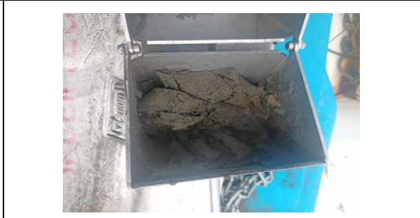
Fotografía 2. Uso de draga tipo Van Veen
