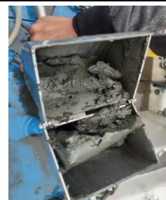
Fotografía 2. Uso de draga tipo Van Veen y apariencia de la muestra
