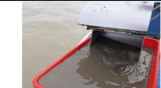
Fotografía 2. Uso de draga tipo Van Veen
