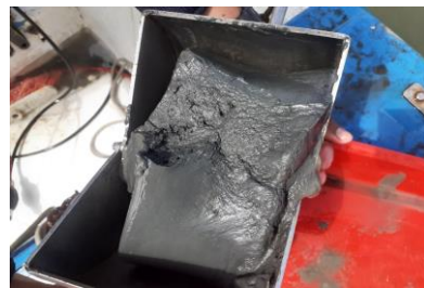
Fotografía 2. Uso de draga tipo Van Veen y apariencia de la muestra
