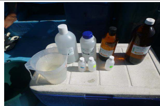
Fotografía 4. Muestra rotulada, envasada y preservada.
