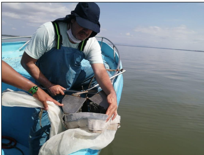
Fotografía 5: Adquisición de muestra bentónica con draga tipo Van Been, muestra depositándose en tamiz de 300 micras para limpieza y concentración de muestras.
