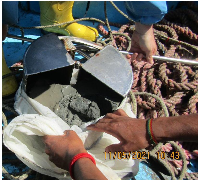
Fotografía 6 y 7: Adquisición de muestras bentónicas en Barra interna depositándose en un tamiz de 300 micras para limpieza y concentración de muestras arriba Barra interna 1 con fondo con mayor presencia de arena y conchiilla, barra interna 2 con fondos grises y mas compacto.
