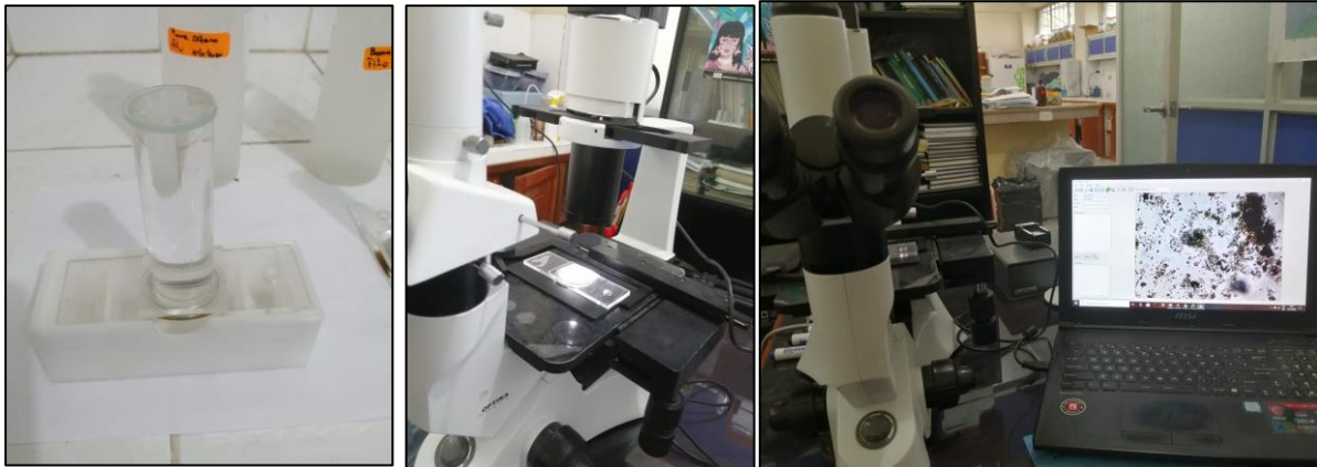
Fotografías 7 a 9: Análisis Fito planctónico en cámaras de Utermohl
