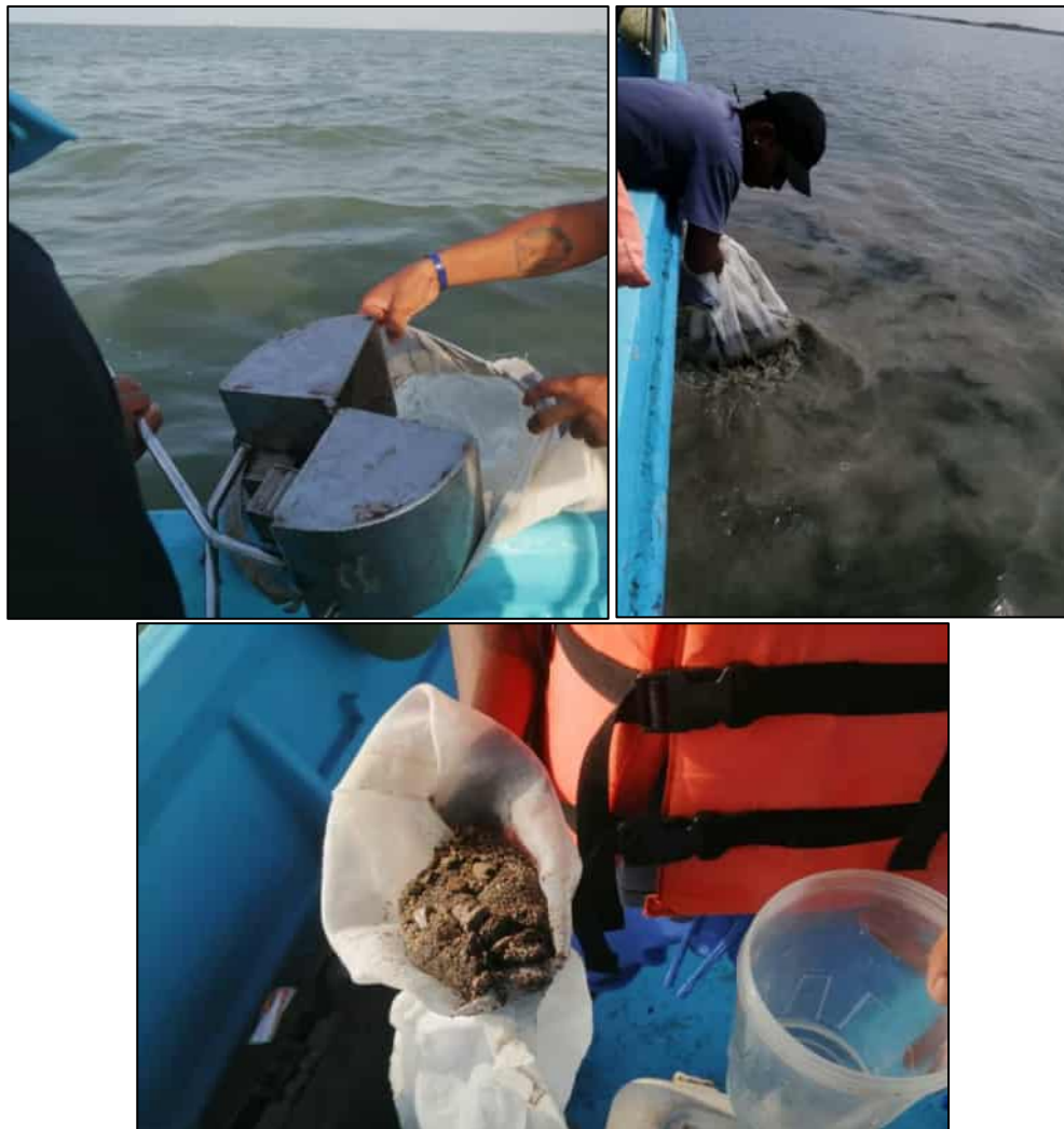
Fotografías 11 a 13: Adquisición de muestra bentónica con draga tipo Van Been, concentración de muestra
