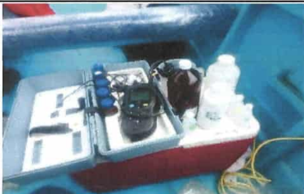
Fotografía 3. Kit de envases de la muestra y medición de parámetros in situ.
