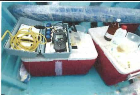
Fotografía 3. Kit de envases de la muestra y medición de parámetros in situ.
