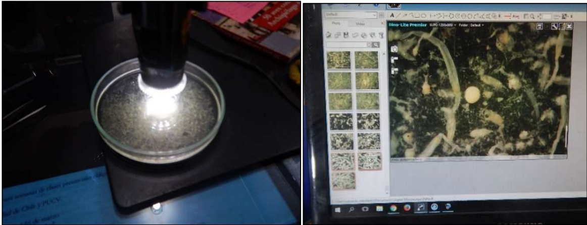
Fotografías 18y 19: Análisis zoo planctónico examinación en lupa de una fracción de masa conocida, imágenes proporcionadas por microscopio DINOLITE que facilitan identificación y conteos
