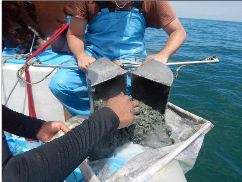
Fotografía 2: Adquisición de muestra bentónica, draga utilizada y tamiz de 500 micras
