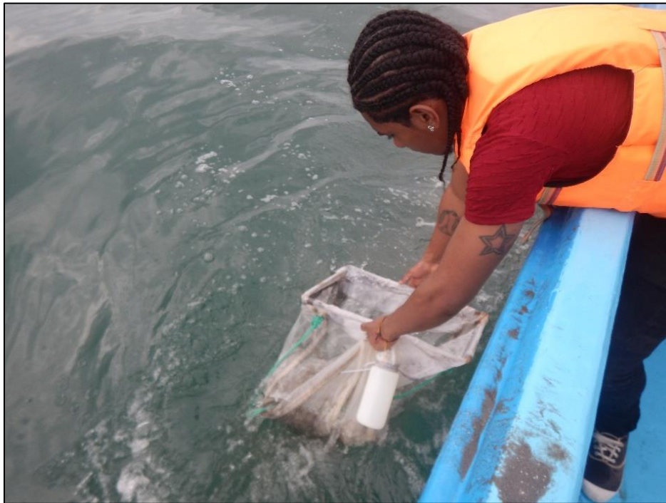
Fotografía 3: Reducción de muestras con tamiz de 500 micras
