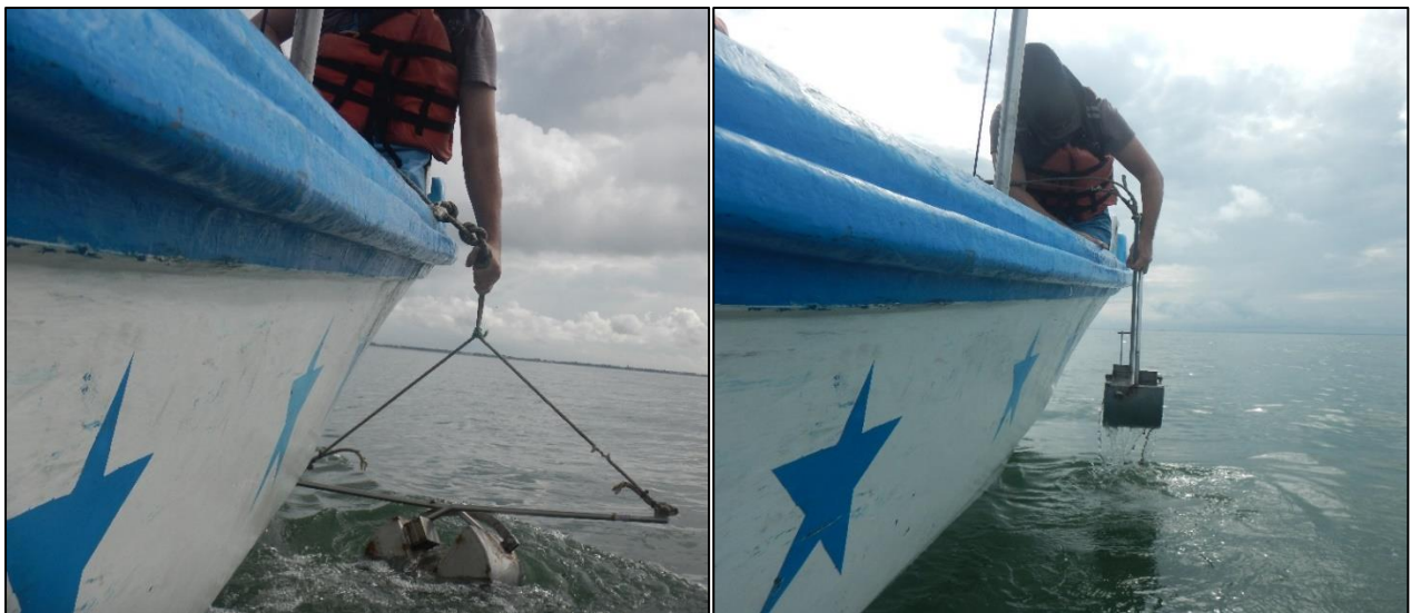
Fotografías 1 y 2: Draga tipo Van Been empleada
