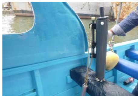
Fotografía 4. Uso de botella Niskin para muestreo a profundidad.
