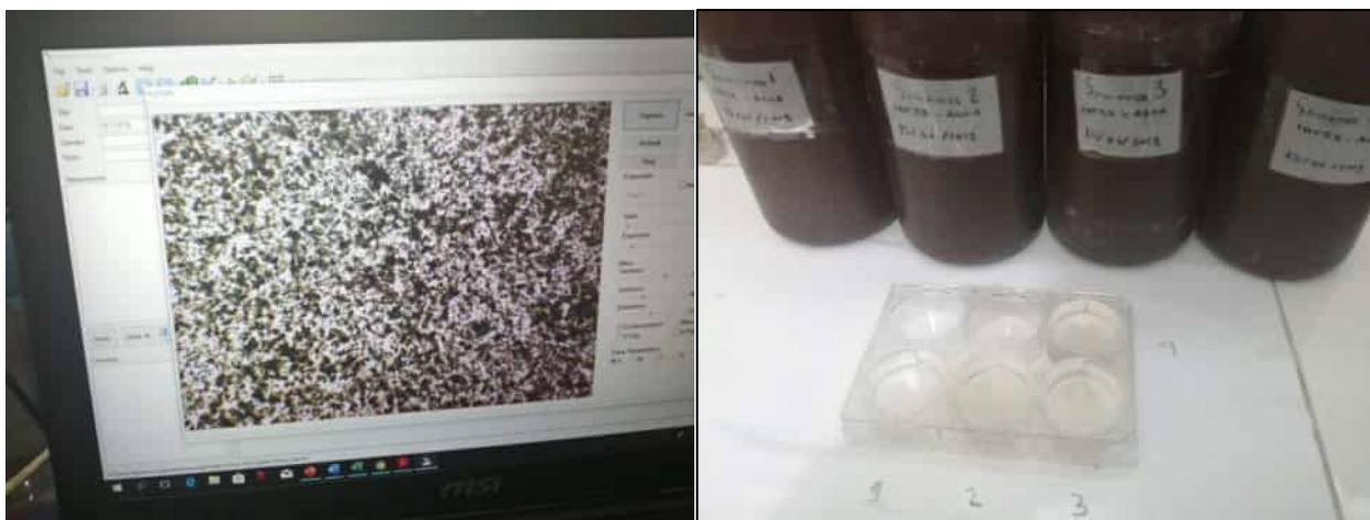
Fotografías 18 y 19: Exceso de sólidos en suspensión en muestra decantada de 25 ml, Cámaras de 10 ml empleadas para observación sin dilución.
