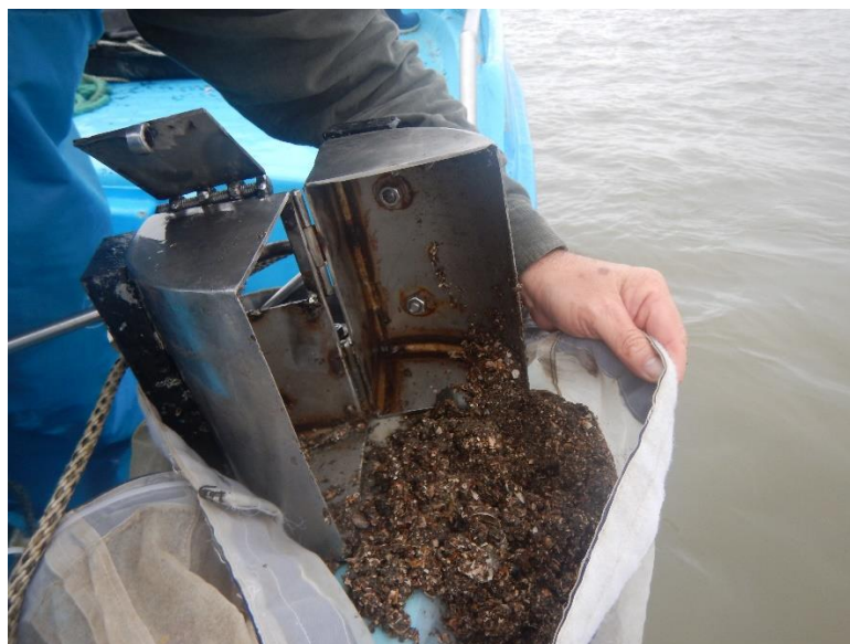
Fotografía 9: Adquisición de muestra bentónica con draga tipo Van Been, nótese el cambio de fondo de Barra Interna 1, en la cual en la actualidad predomina grava y conchilla.
