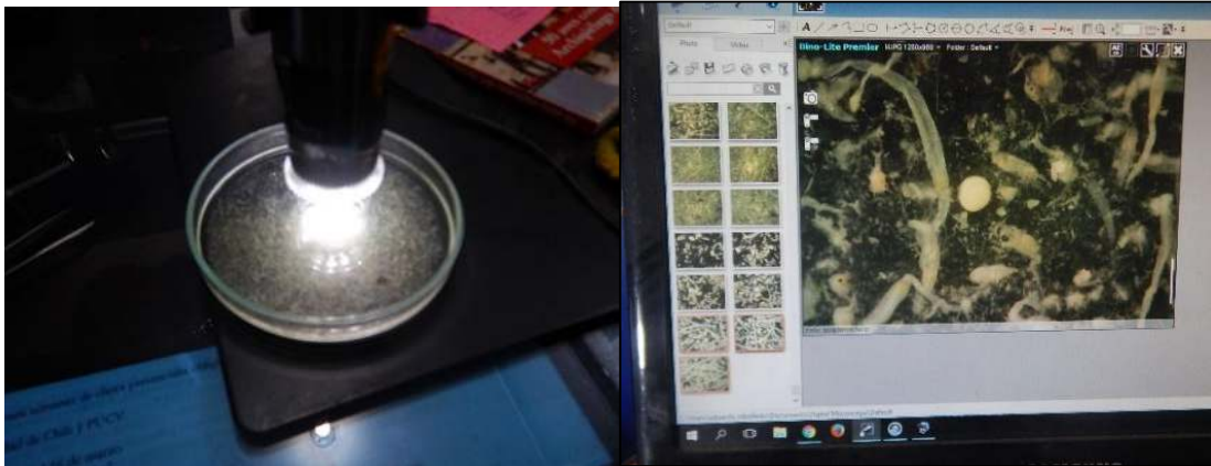
Fotografías 17 y 18: Análisis zoo planctónico, examinación en lupa de una fracción de masa conocida, imágenes proporcionadas por microscopio DINOLITE que facilitan identificación y conteos.
