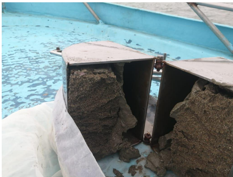
Fotografía 6: Adquisición de muestra bentónica con draga tipo Van Been, muestra depositándose en tamiz de 300 micras para limpieza y concentración de muestras.
