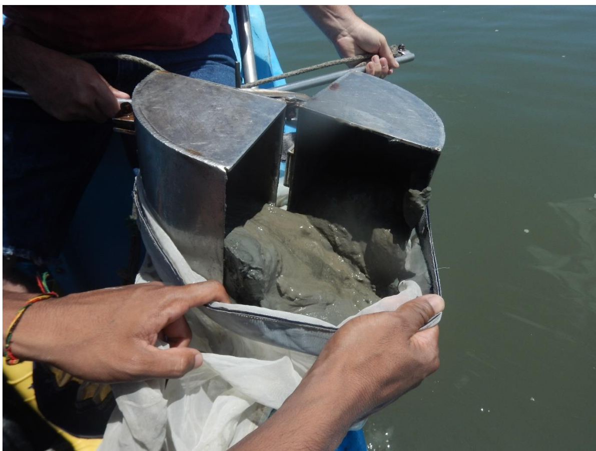
Ilustración 2: Adquisición de muestra bentónica, draga Van Veen utilizada.
