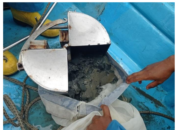
Fotografía 5: Adquisición de muestra bentónica con draga tipo Van Been, muestra depositándose en tamiz de 300 micras para limpieza y concentración de muestras arriba Barra interna 1 con fondo mas compacto y abajo barra interna 2 con fondos con mayor grado de hipoxia y evidente generación de compuestos sulfurosos denotados por su olor a huevo podrido
