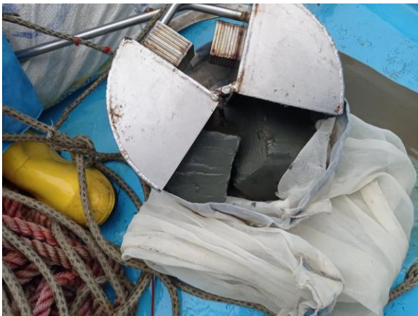
Fotografía 5: Adquisición de muestra bentónica con draga tipo Van Been, muestra depositándose en tamiz de 300 micras para limpieza y concentración de muestras arriba Barra interna 1 con fondo mas compacto y abajo barra interna 2 con fondos con mayor grado de hipoxia y evidente generación de compuestos sulfurosos denotados por su olor a huevo podrido
