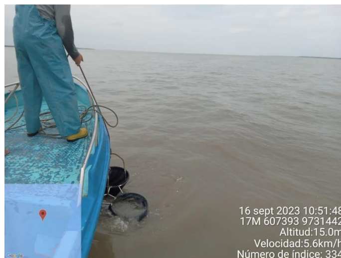
Fotografías 6: Red tribongo empleada en arrastres horizontales y copos retirados con muestras concentradas de 300 y 500 micras
